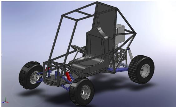
Figura 2. Desenho da estrutura de um Mini Baja.
