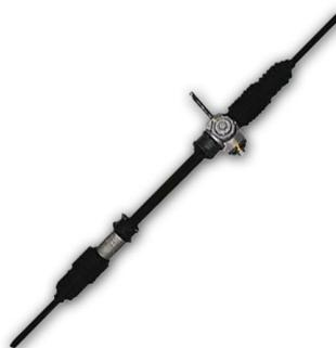
Figura 12. Sistema de barra de direção com pinhão e cremalheira
