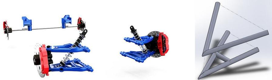
Figura 9. Desenho da suspensão no SolidWorks. Figura 10. Esboço da suspensão elaborado no SolidWorks
