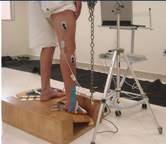
Figura 5: Cenário da coleta de dados. O atleta sobre a plataforma de simulação de entorse desarmada, com a célula de carga suspensa para marcar no sinal o exato momento do desarme e o eletromiógrafo conectado aos eletrodos preso no atleta.
